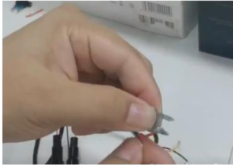
(4) 最后分别将电压为 12V 的常电保险丝和 ACC 电源保险丝插回原车对应的保险丝位置。
